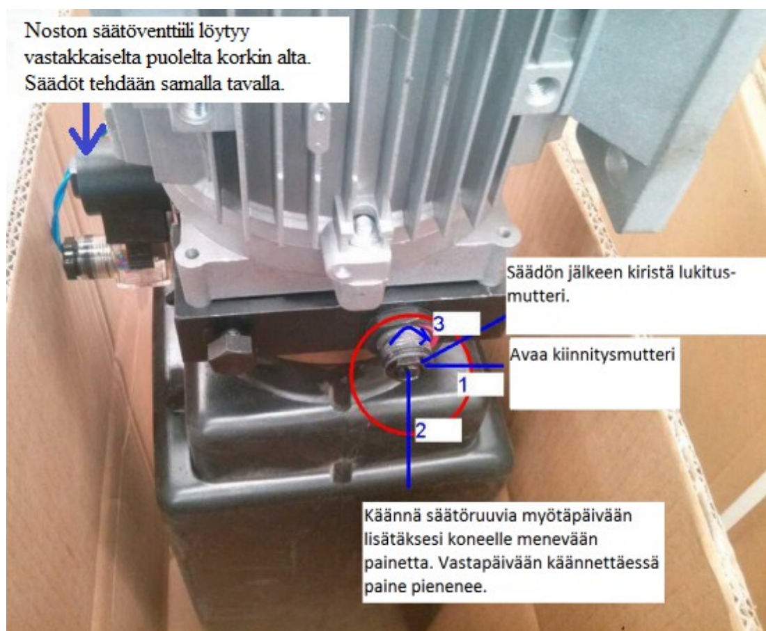
Kuva 18. Nosto- ja laskupaineen säätäminen
